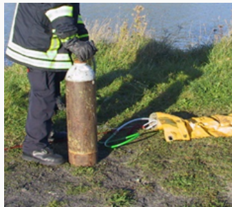
Befüllen der Ölsperre mit der Pressluftflasche (300 bar)
