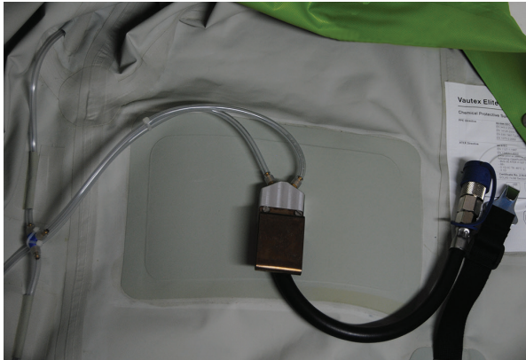
Dual AirLine System mit Verschlauchung im Chemikalienschutzanzug. Mitteldruckleitung montiert am System.
