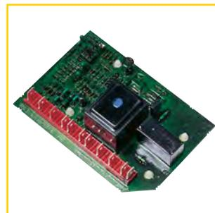
Zusätzliche Schutzmaßnahme gegen Berührungsspannung nach VDE 0100 Teil 410. Mit Meldeleuchte. IT-Netz mit ständiger Isolationsüberwachung zwischen Netz- und Schutzleiter.
