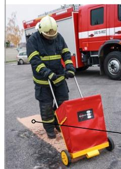
Die Konstruktion des Wagens ermöglicht die Beistellung des Wagens zum Einsatzort ohne Verlust des Ölbindemittels. Das Streuen erfolgt durch Vorwärtsbewegung. Für den Transport zu einem anderen Ort dient die Rückwärtsbewegung, wann das Ölbindemittel nicht ausgebracht wird. Das Streuen vom Ölbindemittel ist so hocheffektiv.
