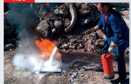
Löschen eines Benzin-Diesel-Petroleum-Gemisches mit einem Metallbrandlöscher befüllt mit Extover® 0,1-0,3 mm.
