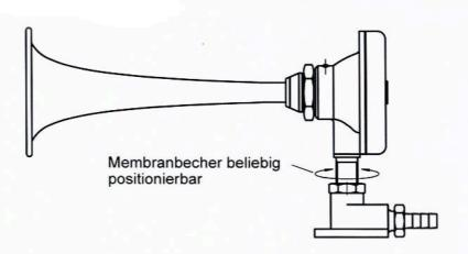
Durch unseren neu entwickelten Halter aus Aluminium eloxiert wird die Montage vereinfacht. Die Becher können von einer Seite montiert und in jeder Richtung fixiert werden. Der Halter ist auch mit den Winkelanschlussstücken Art.-Nr.: 2568.14 kombinierbar. Um Einbauhöhe einzusparen kann der Gewindestutzen um 15mm gekürzt werden (Späne im Membrangehäuse vermeiden).
