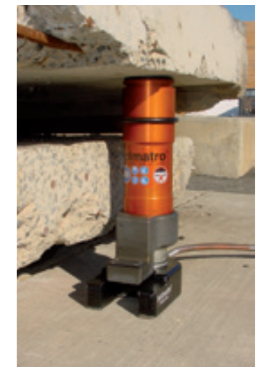
So wird Raum für den Einsatz eines Hebezylinders geschaffen
