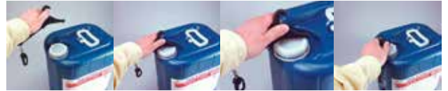
Die Szene zeigt den Einsatz des Kupplungsschlüssels 4577 zum Öffnen von Schaummittelkanistern.
