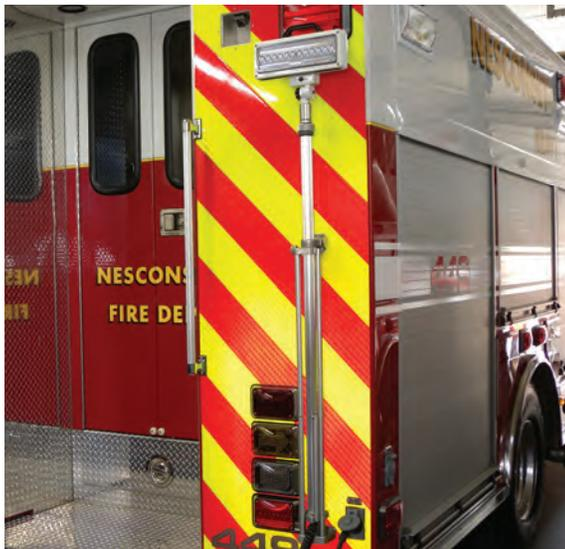
Das Zubehörteil Schnellentriegelungs-Stativhalterung (-603) erlaubt die Befestigung jedes Twist-Lock Teleskop-Dreibeinstatives mit Spectra-Strahler sowohl innerhalb wie außerhalb von Fahrzeugen.
