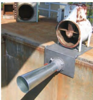
Der Venturi Lüfter arbeitet mit einem pneumatischen Luftschlauch und verwendet keine beweglichen Teile oder Rotorblätter.
